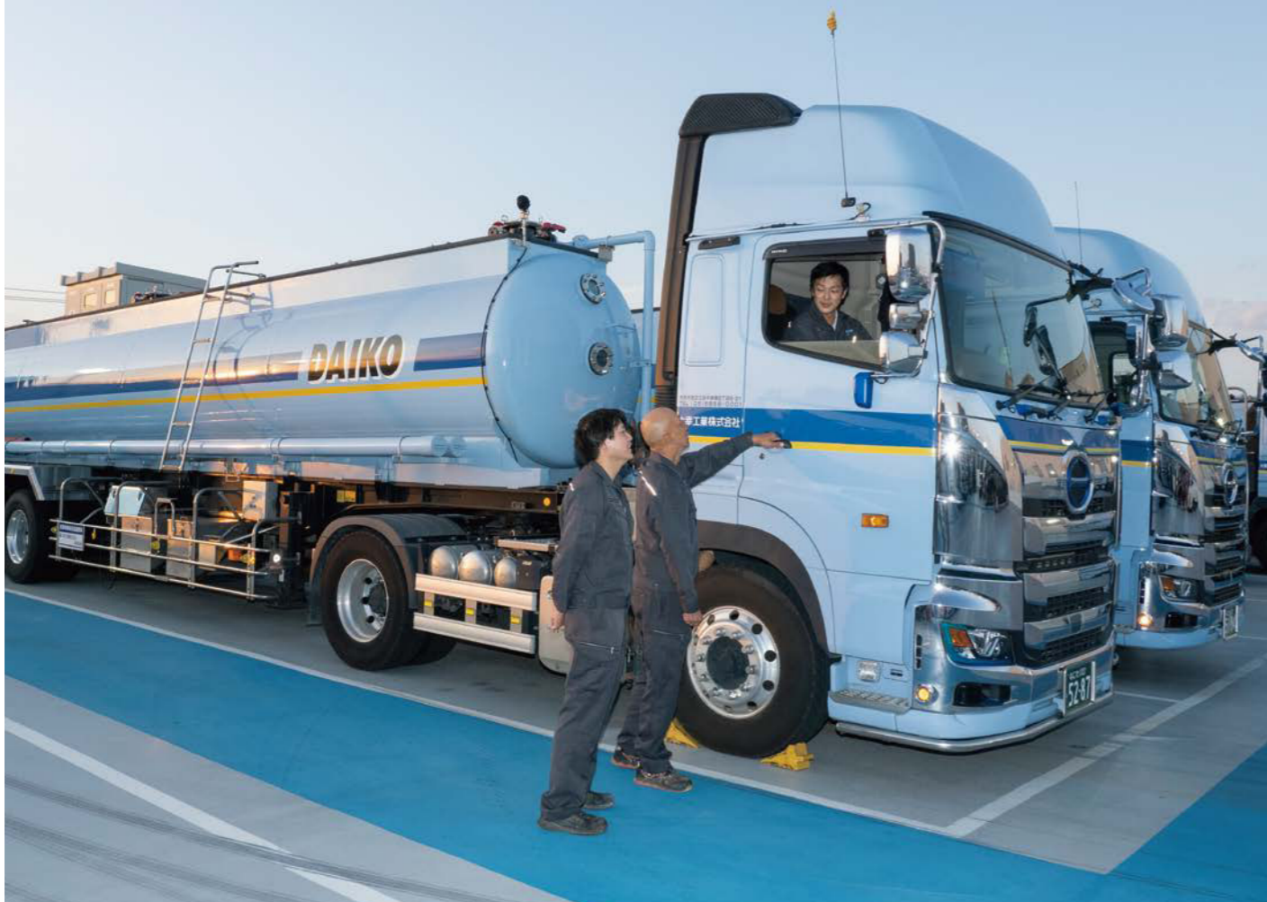
牽引免許が必要な20tタンクセミトレーラー
