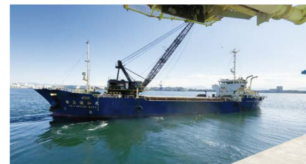
粉塵対策及び降雨による影響を受けないよう密閉式ガット船で運搬
