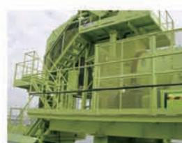
粘土と砂に分級（ふるい分け）するため、発生土をほぐし水で洗浄します。洗浄水は濁水処理装置と処理水槽を経由して洗浄用水槽に戻され、循環使用します。
