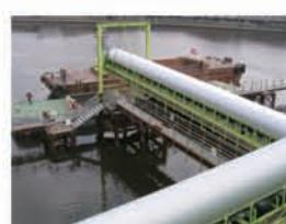
適切に改質処理された処理土は、ベルトコンベアによって積出棧橋へと運ばれ、土運船で第6貯木場に投入され、埋立用資材として活用されます。
