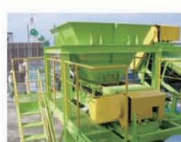
脱水ろ過装置で処理された脱水ケーキは、投入ホッパーを経由して、改質処理土と混合調整、改質を行い、第6貯木場の埋め立て用資材として活用されます。
