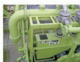
解泥処理された発生土は、粒子の大きさによって、2次分級機、3次分級機による振動篩いと、サイクロン付きロータリー分級機によって分けられます。
