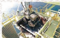
グラブクレーン
