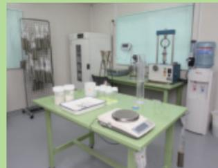
品質管理室では、受け入れた建設汚泥の受け入れ検査や、コロイドポリマー溶液の品質管理を行っています。また、フロー試験、ブリージング試験、一軸圧縮試験などの流動化処理土の品質管理を行っています。
