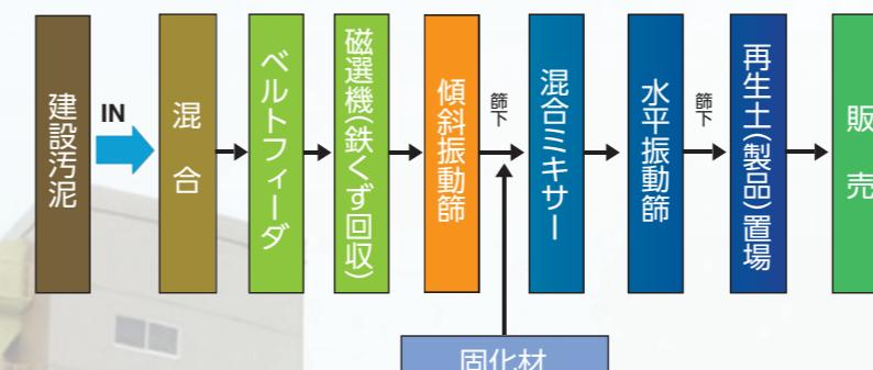
令和2年12月には、建設汚泥を100%リサイクルし、再生土「ポリアース」を製造する固化再生施設が完成しました。
