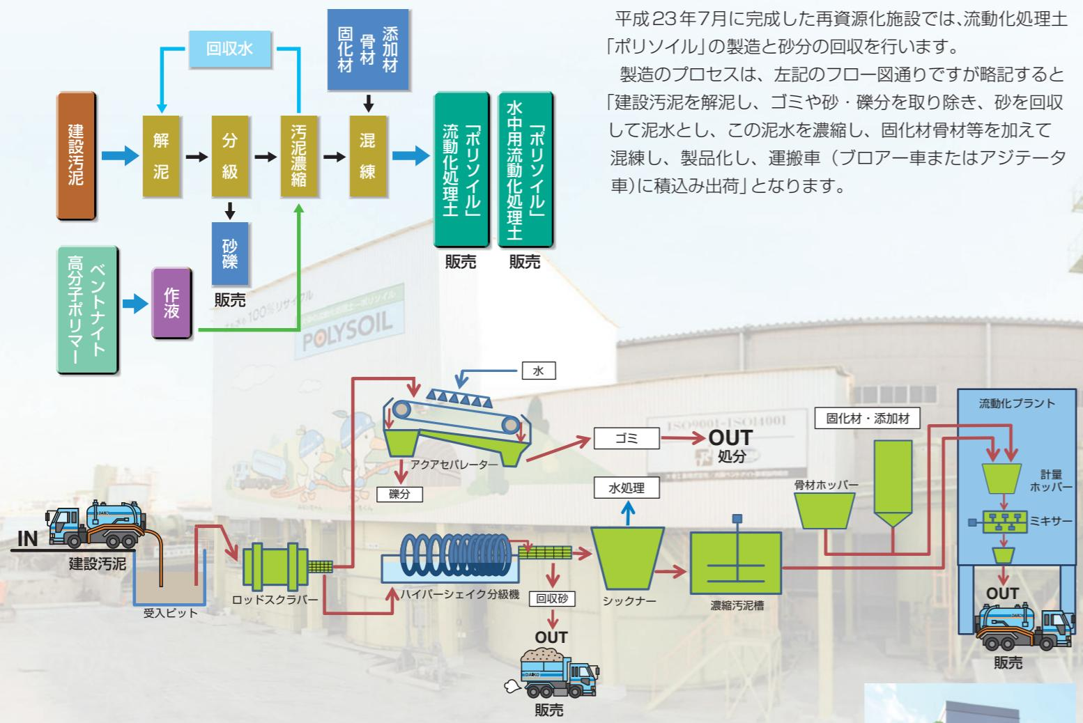
平成23年7月に完成した再資源化施設では、流動化処理土「ポリソイル」の製造と砂分の回収を行います。
