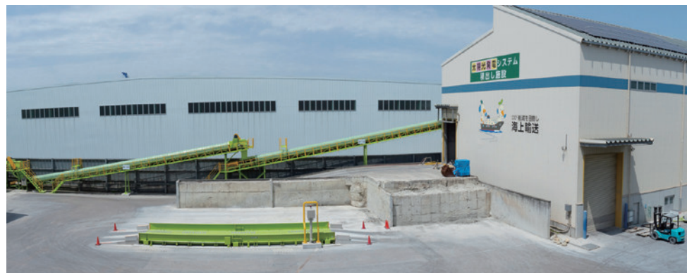
製造設備から製品保管倉庫へ再生土を運ぶベルトコンベア
