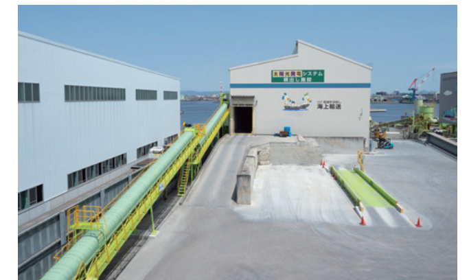
製品保管倉庫へ再生土を運ぶベルトコンベア
