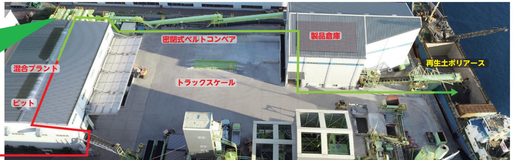
再生土ポリアースは、原料の建設汚泥受け入れから、搬出用船舶積み込みまで、野外に野積されることはありません。すべて、屋根付きの混合プラント、ベルトコンベア、製品倉庫で、降雨にさらされないように製品として取り扱いがされています。
