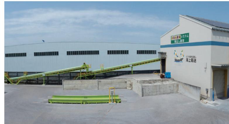
製品倉庫へのベルトコンベア
