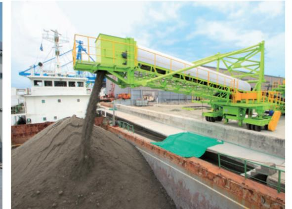
プライベートパス ベルトコンベアにて船積み
