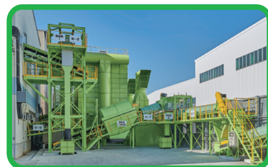
傾斜・乾式篩 水平・乾式篩 三連の磁選機
