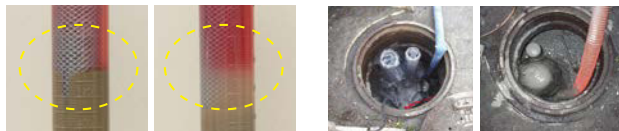
水中用ポリソイル 通常のポリソイル 充填前 充填後
