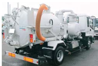
4トン強力吸引車 40 風量 (オールステンレス使用)
